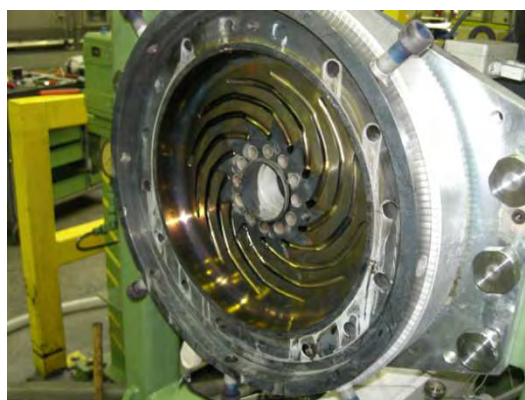
Bild 20 Ansicht ETA - Cirkularverteiler - CVI
