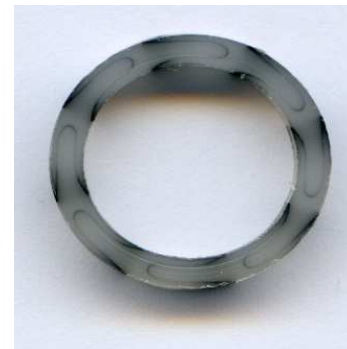
Bild 9 Typische Wandstruktur Ausbildung der "Doppelsichel"
